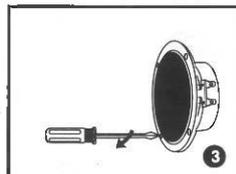
Atornilla cada uno de los cuatro tornillos. Las pestañas de bloqueo girarán. Coloque y asegure la unidad a la superficie trasera del panel de yeso. Coloque las tiras de adhesivo. Asegure la rejilla.
