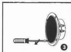
Aparafuse cada um dos quatro Parafusos de cabeça Philips.
