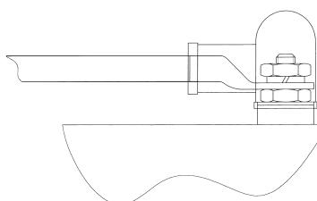
I terminali del motore non hanno una polarità predefinita. Nel caso che la pompa sia collegata a terra collegare il cavo di terra giallo/verde al piede della pompa (vedi cavo D nel disegno). Scegliete le dimensioni del cavo in base alla lunghezza vedi tabella allegata.
