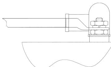
Les terminaux du moteur n'ont pas de polarité pré-définie. Les plombs positifs et négatifs peuvent être connectés à l'un ou l'autre des terminaux. Si la pompe doit être connecté à un câble avec prise de terre, le câble doit être de couleur jaune ou vert et connecté au pied de la pompe. Le plomb négatif doit être noir.
