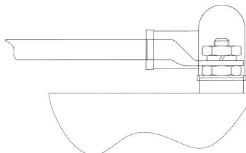
El motor no tiene polaridad. Puede conectarse el positivo a cualquier terminal. Si se desea toma de tierra deberá conectar el cable verde/amarillo a la base de la bomba. El cable negativo será negro. Escoger el diámetro del cable según la distancia y de acuerdo con el cuadro.
