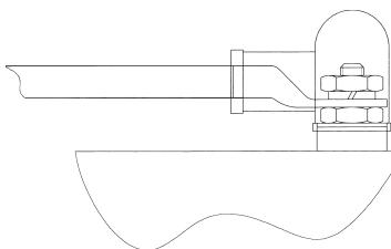
Motorns kontaktskruvar (terminaler) är inte polbestämda varför positiv eller negativ kabel kan anslutas till vilken terminal som helst.
