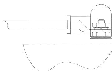
Die Motor-Anschlüsse haben keine vorbestimmte Polarität. Das Minus- oder Plus-Kabel kann an jeden beliebigen Pol angeschlossen werden. Wenn die Pumpe mit einem separaten Masse-Kabel installiert werden soll, nehme man ein gelb/grünes Kabel und verbindet es mit dem Fuß der Pumpe. Das negative Kabel sollte schwarz sein.
