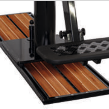
SISTEMA MANUALE DI SCORRIMENTO A PAVIMENTO lunghezza standard 1600 mm (altre lunghezze disponibili su richiesta). Dispositivo manuale per spostare il sedile avanti/indietro e bloccaggio in posizioni intermedie. Non sono applicabili joystick.
