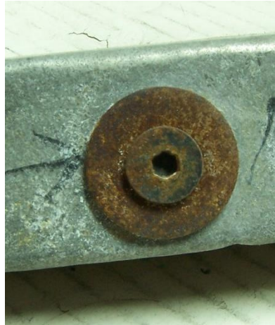
Foto Nº 4. Tornillo Pavonado 1 , apretando probeta roscada de aluminio con arandela y tuerca zincada.
