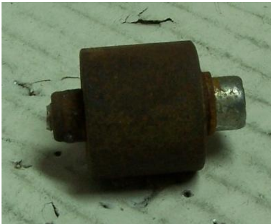
Foto Nº 2. Tornillo de Acero Inox A2-70, apretando probeta rosca de acero comercial con arandela y tuerca zincada.
