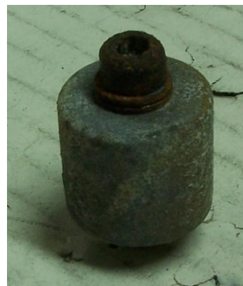
Foto Nº 3. Tornillo Pavonado apretando probeta rosca de zinc , con arandela y tuerca zincada.
