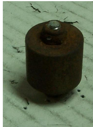
Foto Nº 2. Tornillo de Acero Inox A2-70, apretando probeta rosca de acero comercial con arandela y tuerca zincada.
