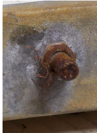
Foto Nº 4. Tornillo Pavonado 1 , apretando probeta roscada de aluminio con arandela y tuerca zincada.
