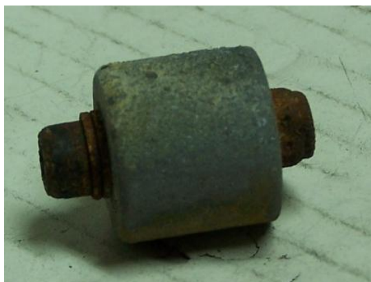
Foto Nº 3. Tornillo Pavonado apretando probeta rosca de zinc , con arandela y tuerca zincada.
