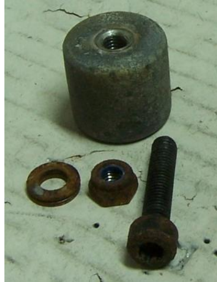
Foto Nº 6. Desmontado del tornillo Pavonado que apretaba probeta roscada de zinc.
