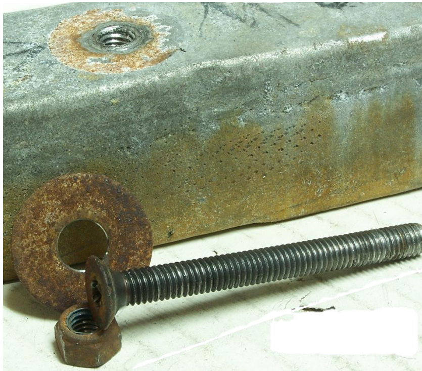
Foto Nº 7. Desmontado del tornillo Pavonado que apretaba probeta roscada de aluminio.
