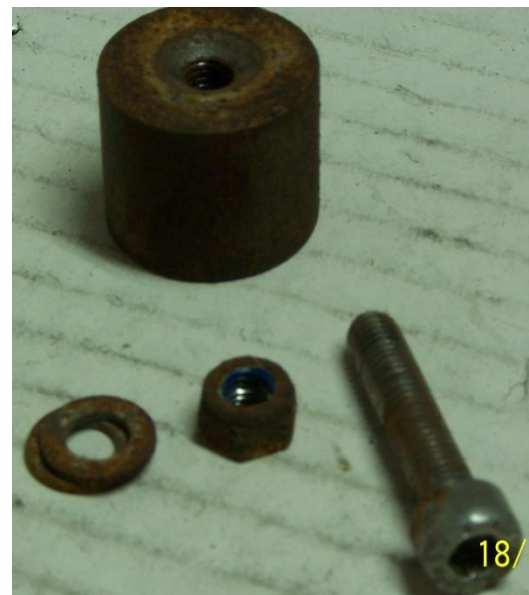
Foto Nº 5. Desmontado del tornillo de Acero Inoxidable que apretaba probeta roscada de acero comercial.
