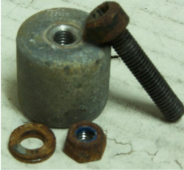
Foto Nº 6. Desmontado del tornillo Pavonado que apretaba probeta roscada de zinc.
