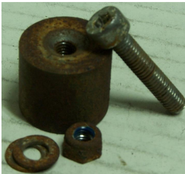
Foto Nº 5. Desmontado del tornillo de Acero Inoxidable que apretaba probeta roscada de acero comercial.
